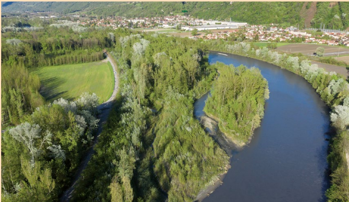
Projet Isère amont - Restauration de l'espace de bon fonctionnement sur le secteur de Pré Pichat à Crolles intégrant le rajeunissement de 9,5 ha de boisement alluvial, la réouverture d'un bras sur 350 ml et d'un bras phréatique sur 600 ml. © Symbhi – Photec.
